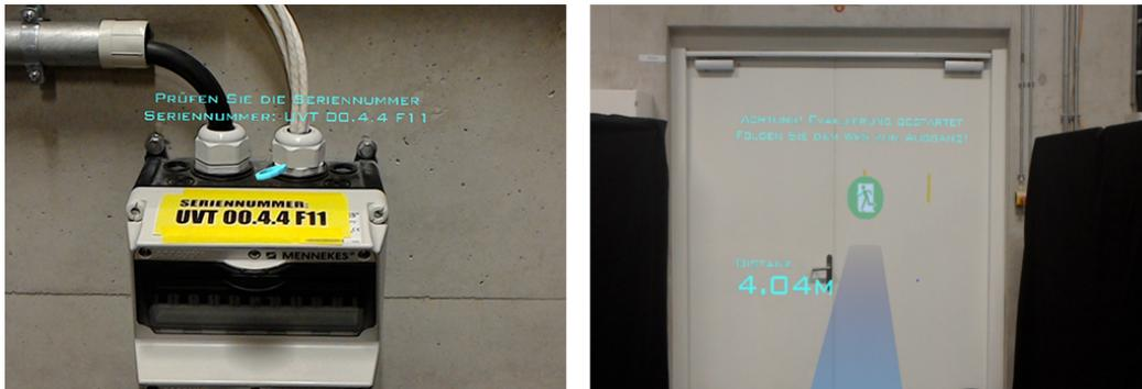
Abbildung 11: Beispielhafte positionabhängige Augmented Reality Information- Links: Die Arbeitsanweisung, eine Seriennummer zu prüfen. Rechts: Die Darstellung einer Evakuationsroute zum Ausgang.
